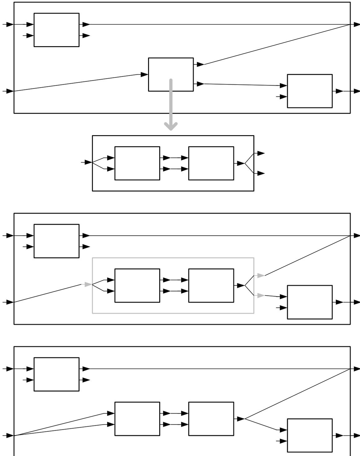
Ein hierarchisches S-Netz (oben) und sein Übergang (mitte) zu einem verflachten S-Netz (unten).
